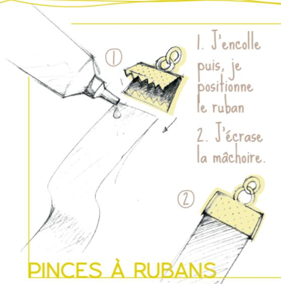
> Les **PINCES À RUBANS**, sortes de mâchoires métalliques dans lesquelles on vient coller le ruban avant de les fermer à l'aide d'un pince plate. Elles existent en différentes largeurs pour s'adapter aux rubans de différentes tailles.
